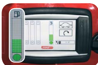
Ablesen des Tankfüllstandes im Still- stand möglich
