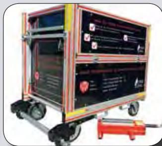
Kugelgelagerte Achse aufstecken und Rollcontainer aufbocken
