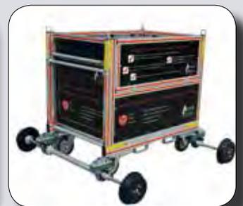
Einstellung der Spurbreite: DB-Spurbreite (1435mm)
