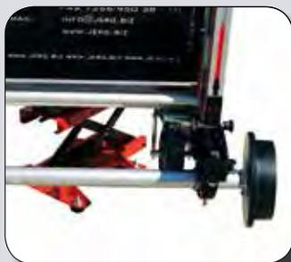
Schienerräder aufstecken und ablassen
