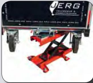
Aufbocken der Lenkradseite mit Wagenheber
