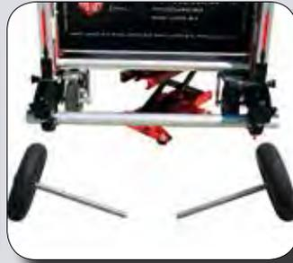
Aufstecken der kugelgelagerten Aufsteckachse und aufbocken
