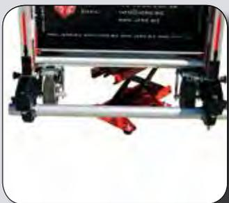
Achse aufstecken und aufbocken auf Nicht-Bremsseite
