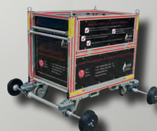
Einstellung der Spurbreite: DB-Spurbreite (1435mm)
