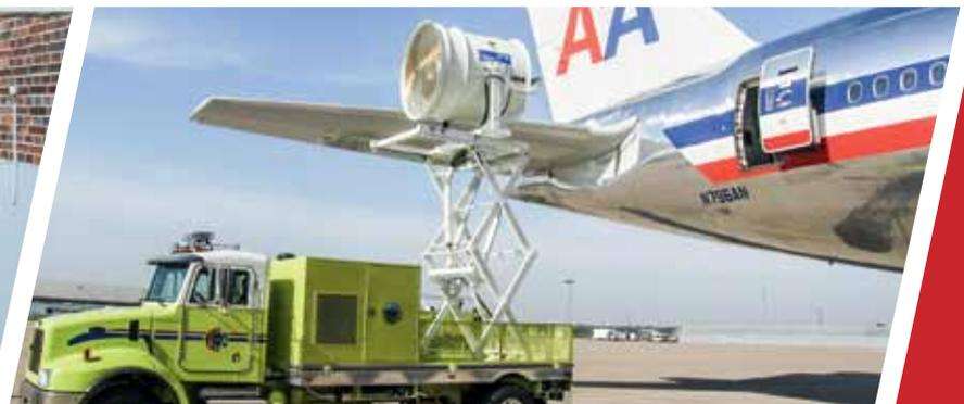
Wir bieten für alle MGV® verschiedene Hub-Dreh-Neige-Vorrichtungen zur optimalen Ausrichtung des Ventilators an. Bei ungünstiger Aufstellmöglichkeit des Fahrzeugs an der Zuluftöffnung entfällt durch die schnelle, einfache Ausrichtung des Ventilators aufwendiges Rangieren im Einsatz. Rettungs- und Fluchtwege können besser frei gehalten werden.
