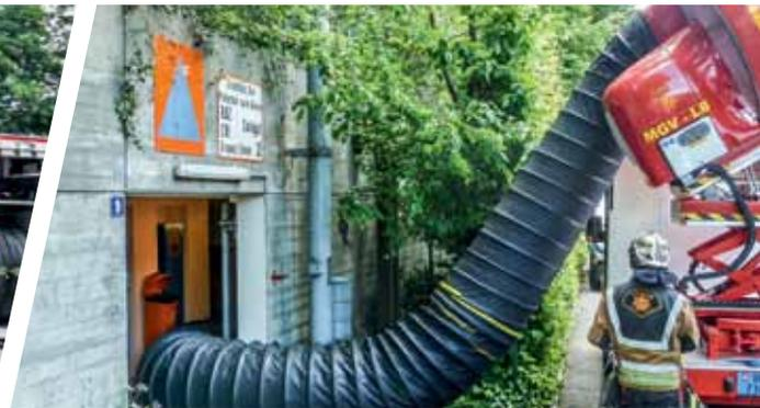
Bei bestimmten Einsatzsituationen ist Überdruckbelüftung aufgrund der Räumlichkeiten nicht möglich, wenn keine Abluftöffnung vorhanden ist oder geschaffen werden kann, oder einsatztaktisch nicht sinnvoll, wenn die Rauchausbreitung nicht kontrolliert werden kann. Beispielsweise ist in einem Krankenhaus eine unkontrollierte Rauchausbreitung eine große Gefahr für Patienten. Mit dem für alle MGV® optional erhältlichen
