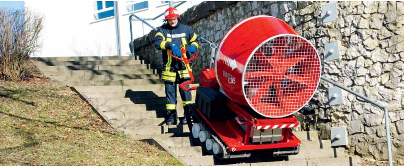
Der MGV® L95 ermöglicht den Einsatz eines leistungsstarken Großventilators auch bei schwer zugänglichen Einsatzorten, die z. B. nur über Treppen oder schmale Wege erreichbar sind. Die kompakten Abmessungen erlauben den Aufbau auf ein Raupenfahrgerüst oder
