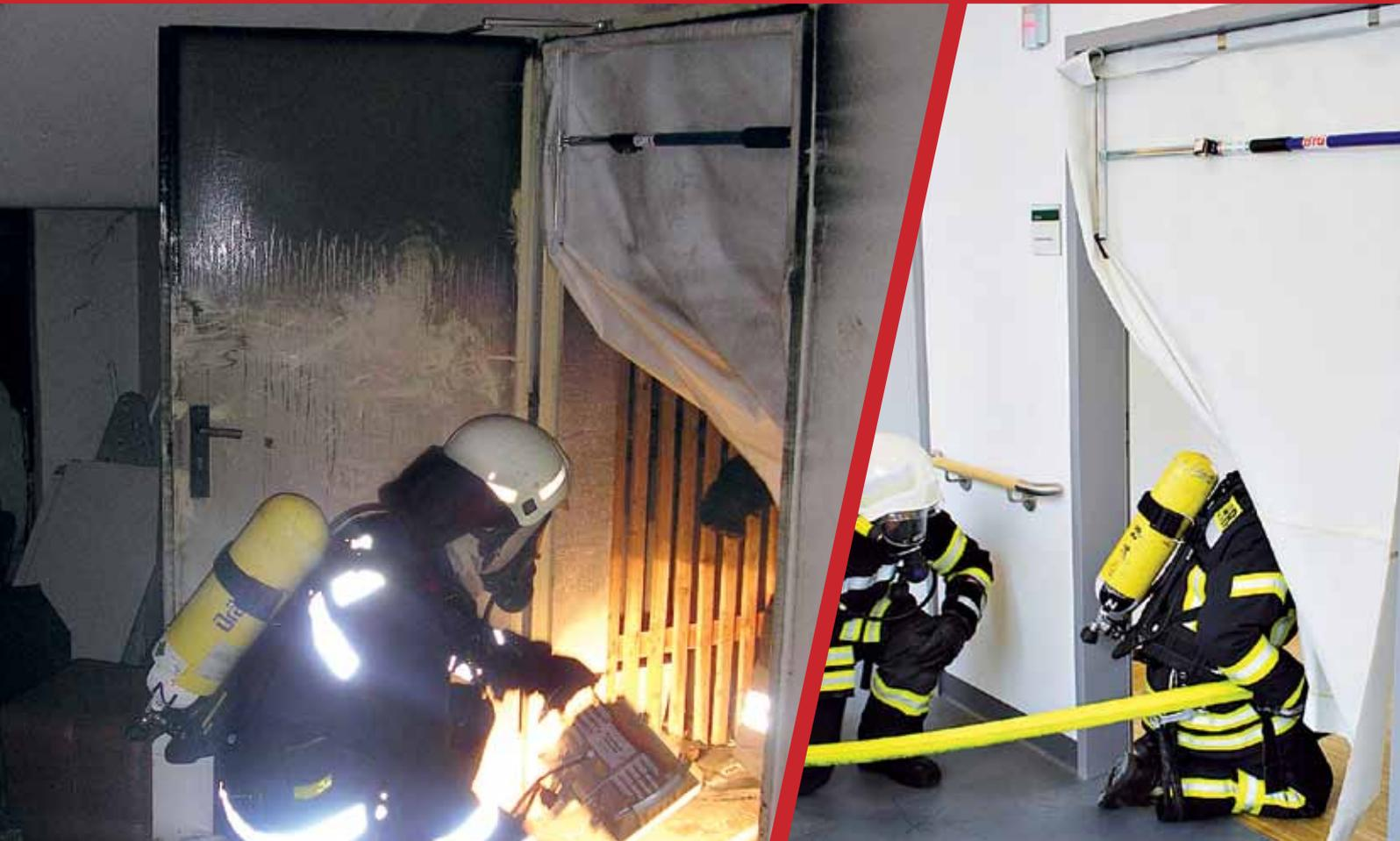
Mit der einfach zu bedienenden Spannvorrichtung kann der Mobile Rauchverschluss aus hitzebeständigem Spezialgewebe schnell und sicher in eine Tür oder Eingangsöffnung eingebaut werden. Die Tür zu dem vom Brand betroffenen Bereich (Rauchgrenze) kann nun geöffnet werden, ohne dass es während des Einsatzes zur Rauch- und Hitzeausbreitung im Gebäude kommt. Die Fluchtwege für Bewohner und die
