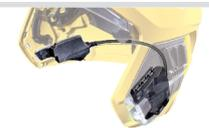
Voll-integriertes Beleuchtungsmodul (Nahbereich)
