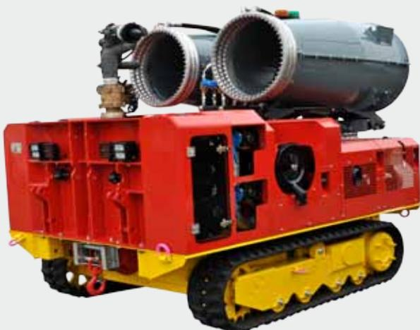
Das Hochleistungsgebläse wird auf ein an schwieriges Gelände angepasstes Kettenfahrzeug montiert. Es überwindet Steigungen von 50 % und Wassertiefen bis zu 550 mm. Seine Geländegeschwindigkeit von 5 km/h lässt sich durch sein Schienenmodul auf 40 km/h steigern. Es wurde als vielseitiges Fahrzeug für Rettungsmannschaften entwickelt.
