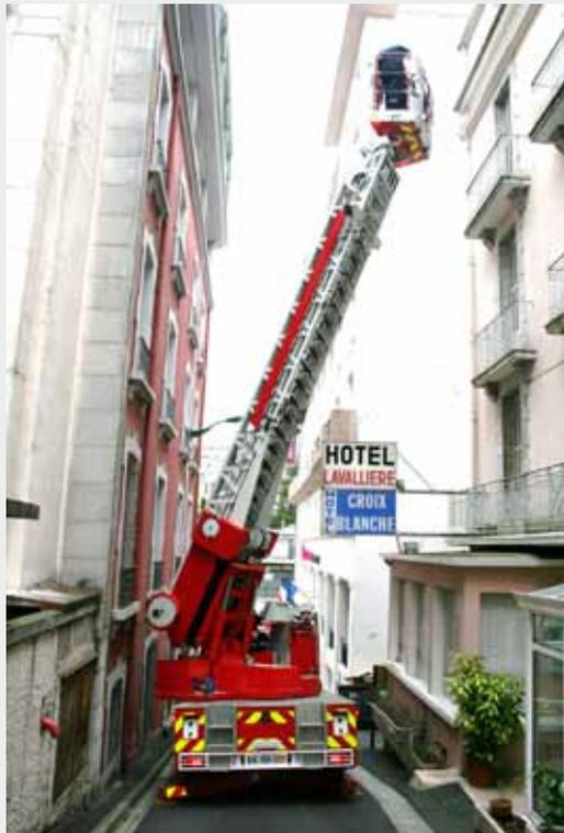
180° Drehung bei einer 7° Grad Steigung mit 5 m Breite
